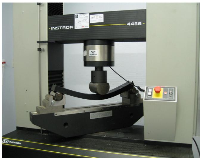
Figura 1 – Exemplo de um dobramento de 3 pontos.
