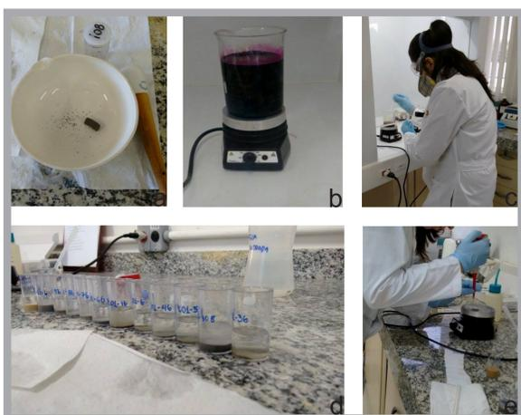
Figura 2: a. Dissolução da Matéria Orgânica b. Reação c. Adição do Ácido Clorídrico d. Amostras e. Confeção das Lâminas
