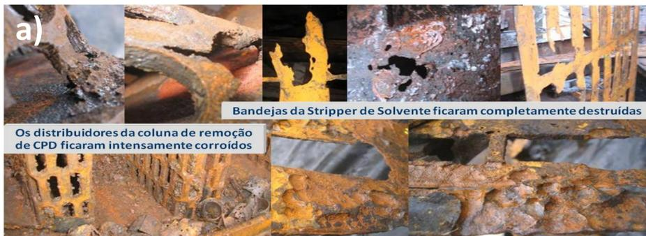
Fig. 1: Corrosão severa em peças submetidas a ambiente contendo aminas
