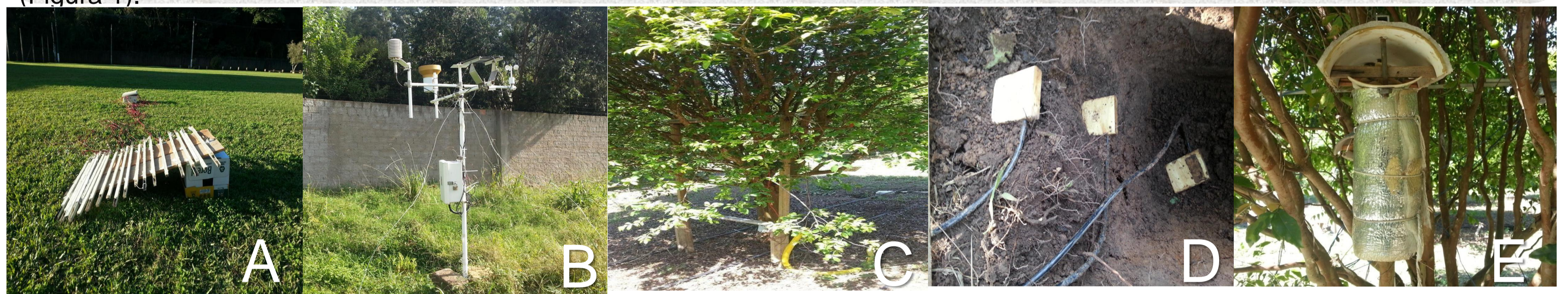
Figura 1: Calibração dos sensores de RFA (A), EMA (B), sensores RFA no dossel (C), sensores TDR no solo (D), psicrômetro (E). Porto Alegre, RS. 2015.
