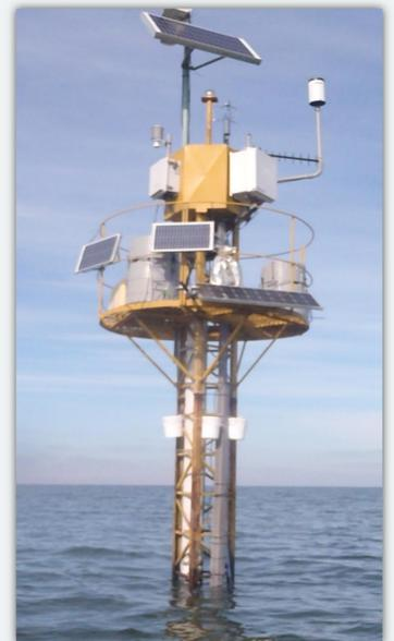
Fig. 2. Torre onde estava instalado o amostrador ISCO 6712, localizada no centro da Lagoa Mangueira, RS.
