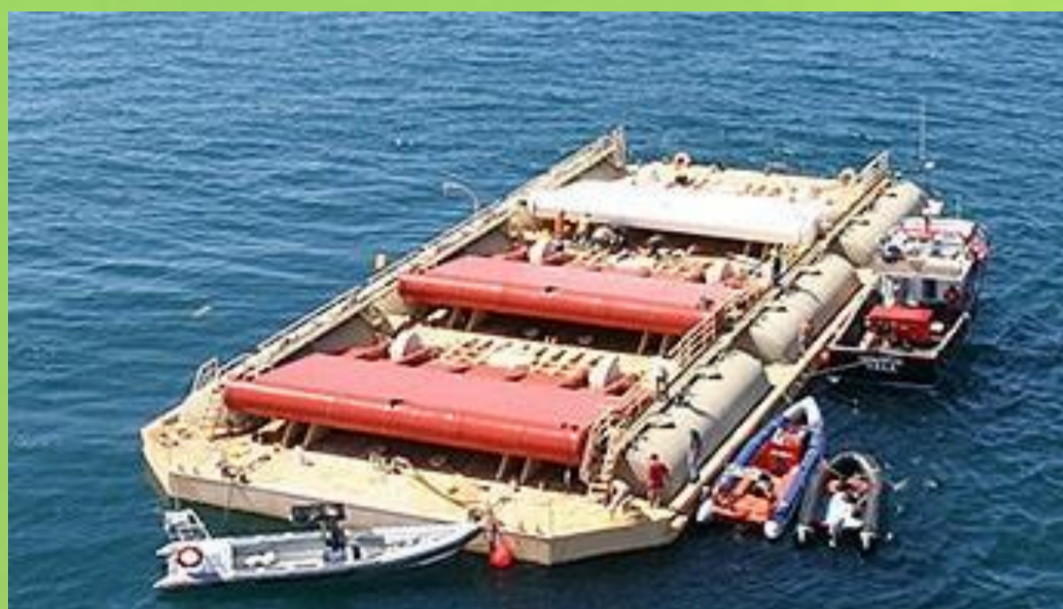
Fig. 1 – Módulo composto por 3 Waverollers (Projeto SURGE, Peniche, Portugal). Foto: Carlos Tiago.
