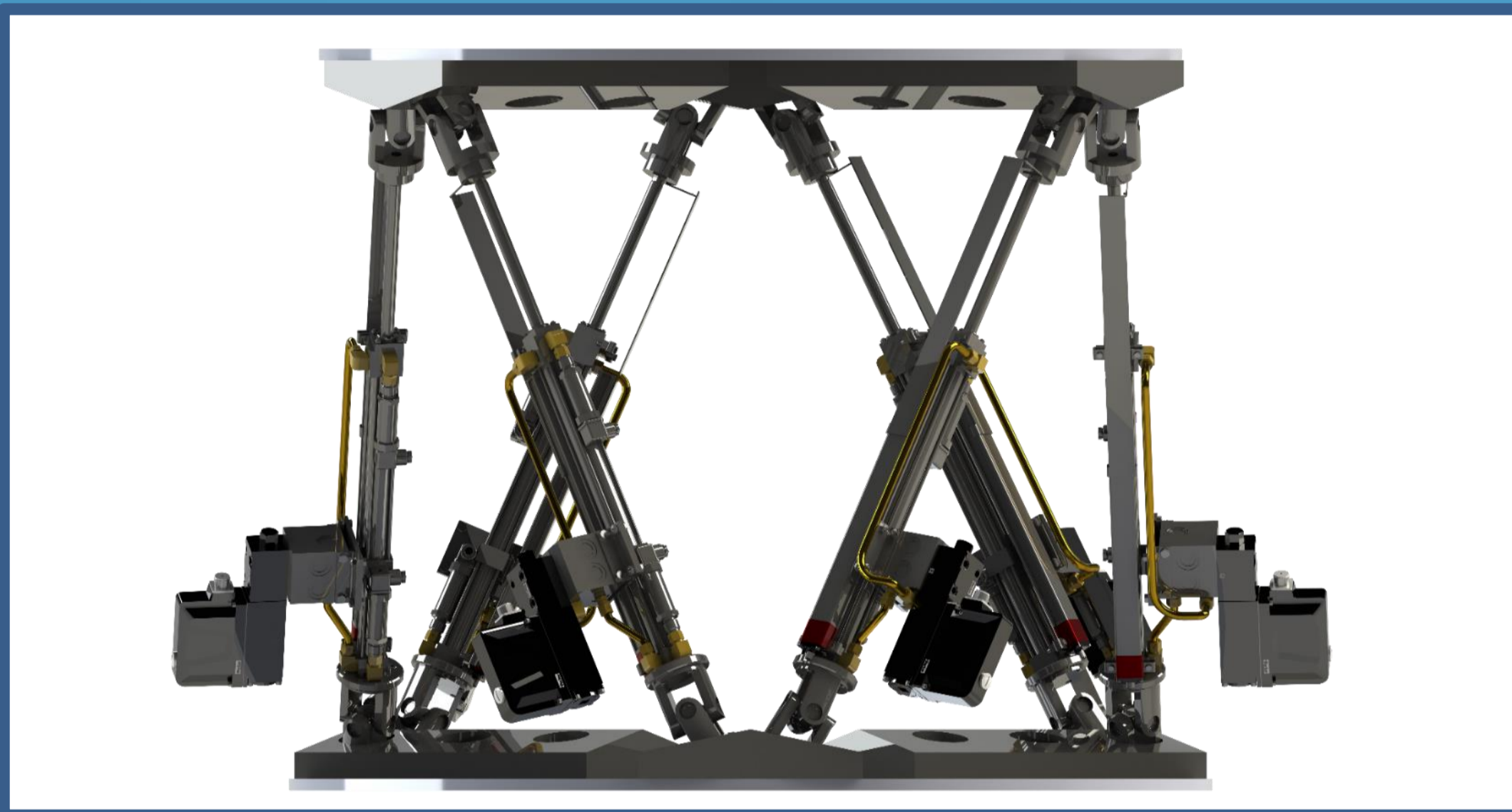
Figura 1. Modelo da Plataforma de Stewart desenhado em software CAD.
