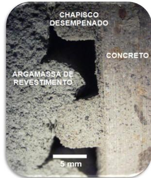
Figura 1 – superfície de contato entre a argamassa de revestimento e o substrato de concreto.<sup>1</sup>
