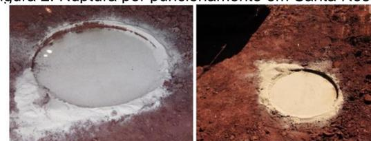
Para o ensaio de placa realizado na cidade de Coronel Barros – RS, foi utilizado a placa de 48 cm, sendo que, devido problemas logísticos, ainda não foi possível realizar o ensaio com a placa de 80 cm. Na Figura 3 observa-se a curva para o ensaio realizado e a imagem da ruptura por puncionamento ocorrida.
