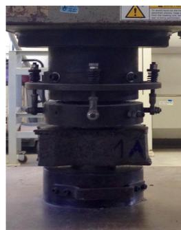
Ensaio de resistência à compressão dos blocos de concreto
