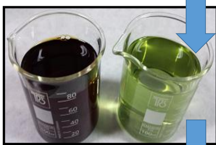
Figura 2. Lixiviado contendo íons \text{Fe}^{3+} (esquerda) e \text{Fe}^{2+} (direita).
