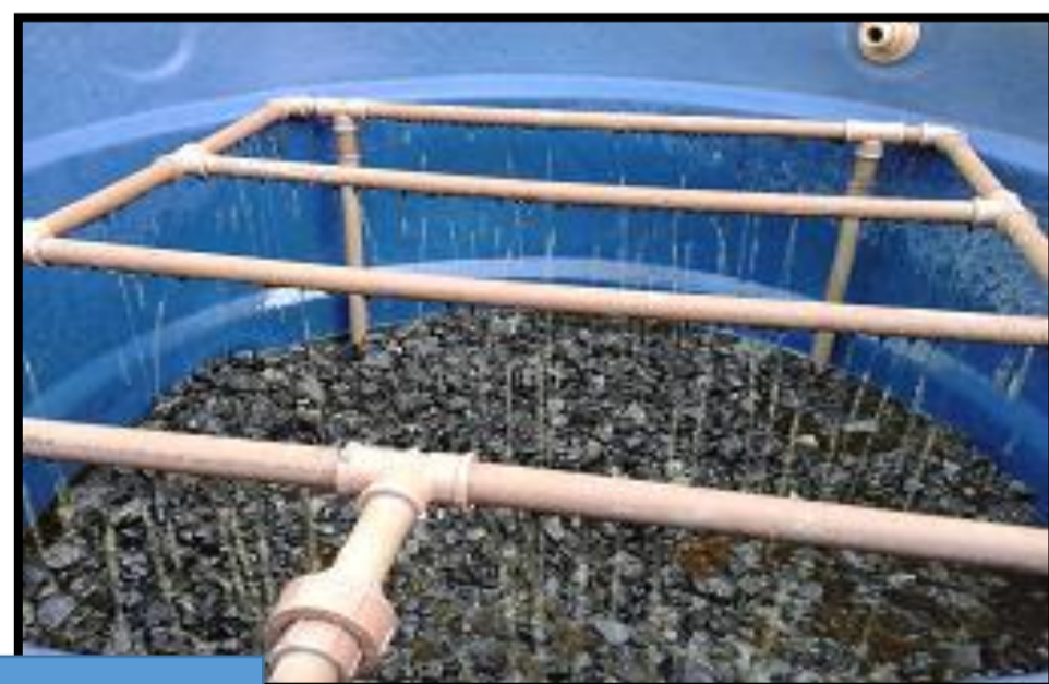
Figura 1. Lixiviação do concentrado de pirita em planta piloto.
