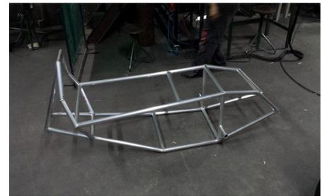
Figura 3 – Chassi do veículo em alumínio
