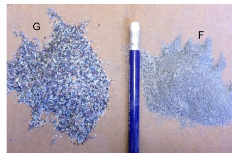
Figura 6 – Comparação de dimensão G (>0,5mm) e F (<0,5mm).
