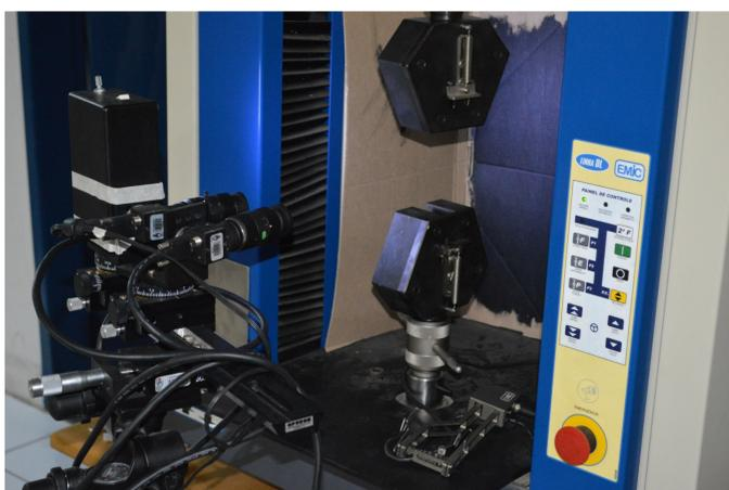
Figura 01: Montagem do ensaio com duas câmeras FLEA2 e iluminação artificial
