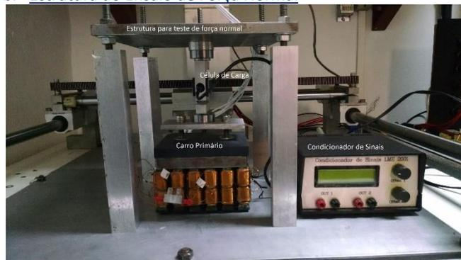
Figura 2- Estrutura para Ensaio de Força Normal
