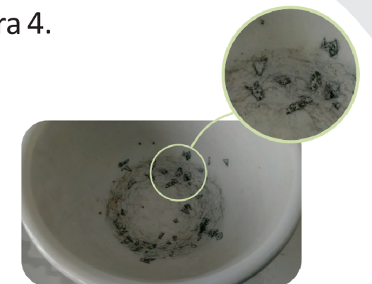
Figura 4 - Presença de polímero na amostra interna.
