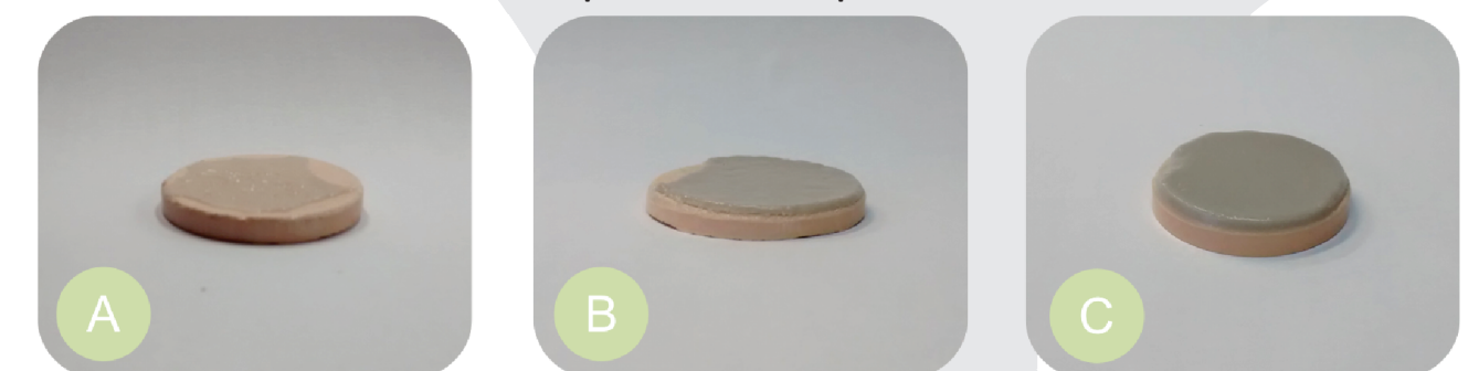
Figura 9 - Pastilhas (A) 1, (B) 2 e (C) 3, após a sinterização.
