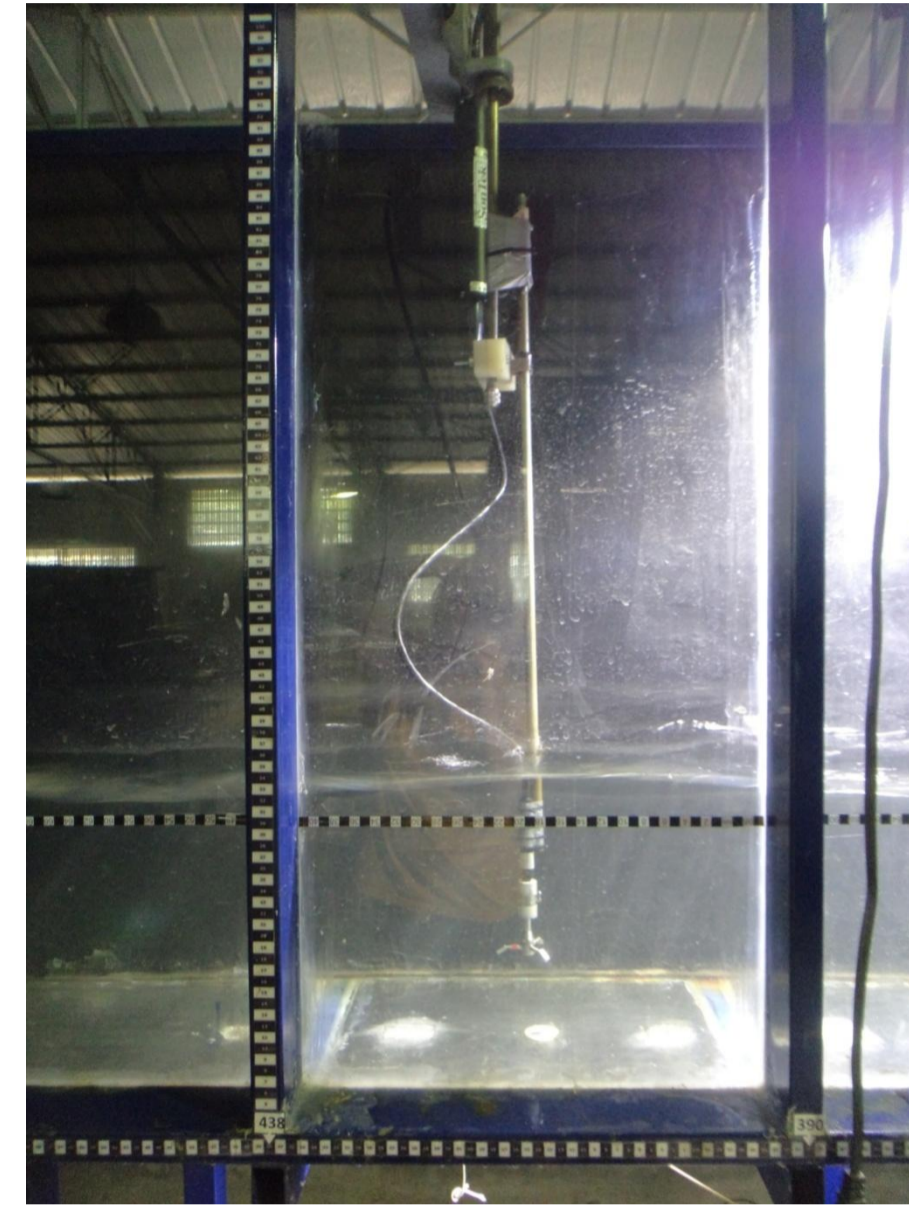
ADV instalado para medição
