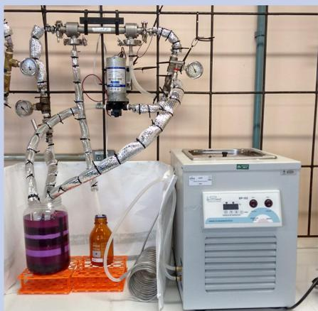
Figura 2: Sistema de microfiltração do extrato de beterraba.
