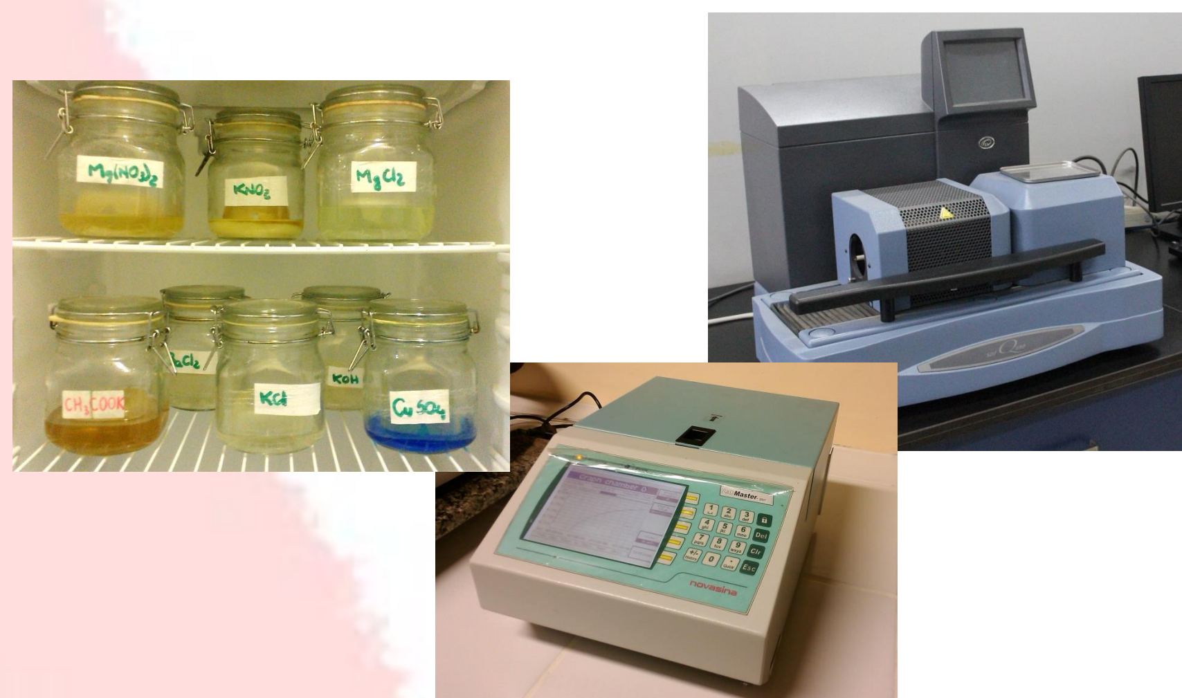
Figura 1: Em ordem anti-horária estão: soluções salinas utilizadas na obtenção de isotermas pelo método gravimétrico; analisador eletrônico de atividade de água; Termo Balança.
