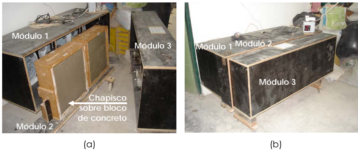
Figura 16: caixa aquecida (a) sendo preparada para o ensaio e (b) fechada, durante a realização do mesmo
