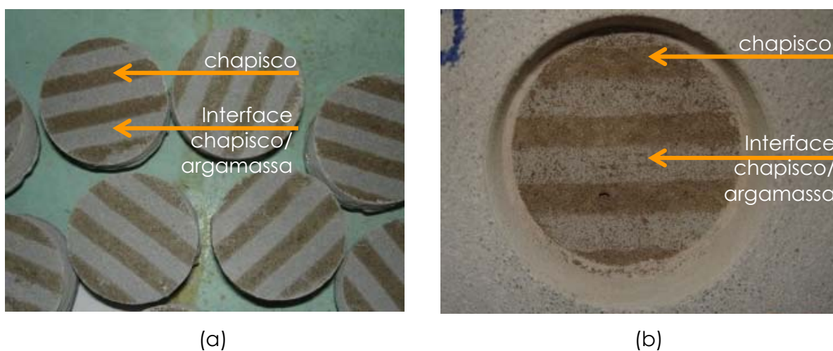
Figura 59: forma de ruptura combinada no chapisco mais na interface argamassa de chapisco/argamassa de revestimento (a) nos corpos-de-prova ensaiados e (b) em um local correspondente no prisma
