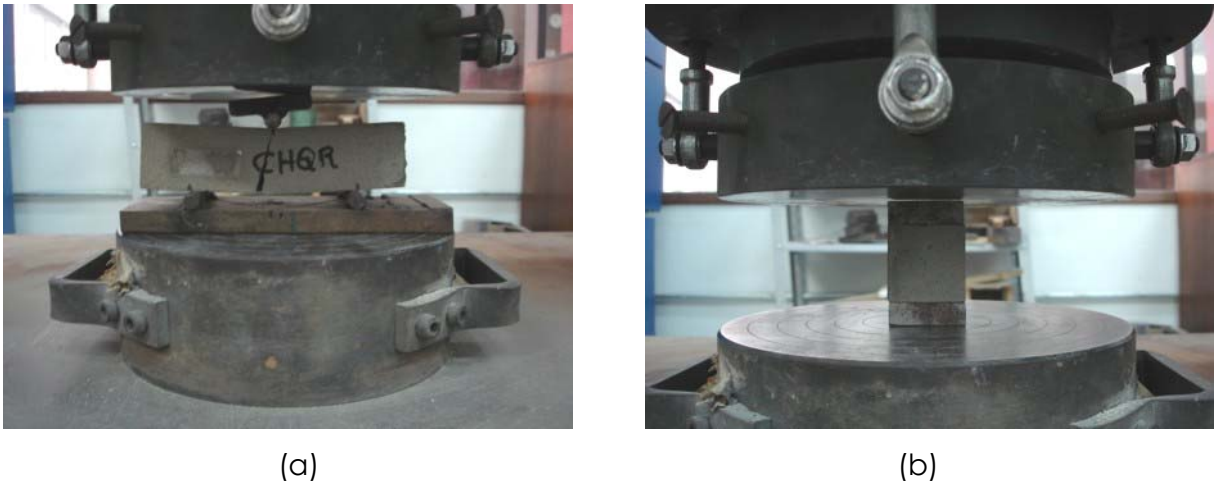
Figura 27: ruptura dos corpos-de-prova (a) prismáticos 4x4x16cm à tração na flexão e (b) metade resultante da ruptura à tração na flexão submetida à compressão
