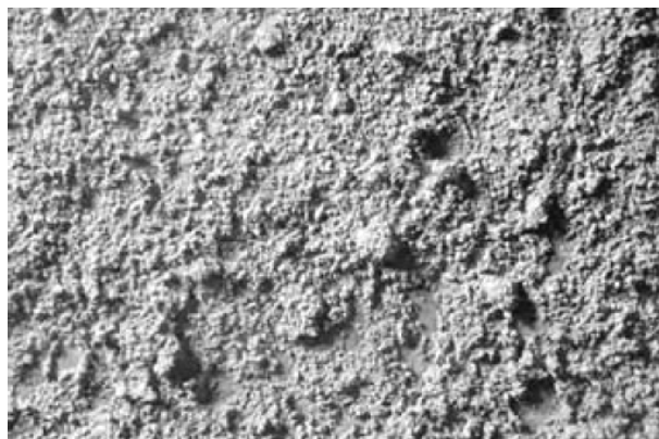
Figura 3: superfície com aplicação de chapisco convencional (CEOTTO et al. , 2005)
