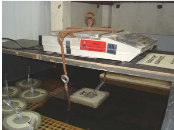
Figura 26: ensaio de sucção capilar em andamento
