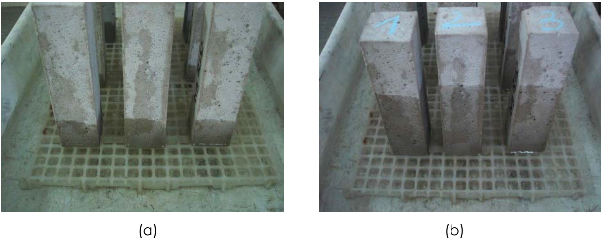
Figura 28: aspecto dos corpos-de-prova devido à sucção capilar (a) aos 10 minutos e (b) aos 90 minutos
