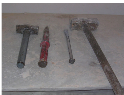
Figura 24: Ferramentas para demolição: marretinha, ponteira, talhadeira e marretão (Empresa 05)
