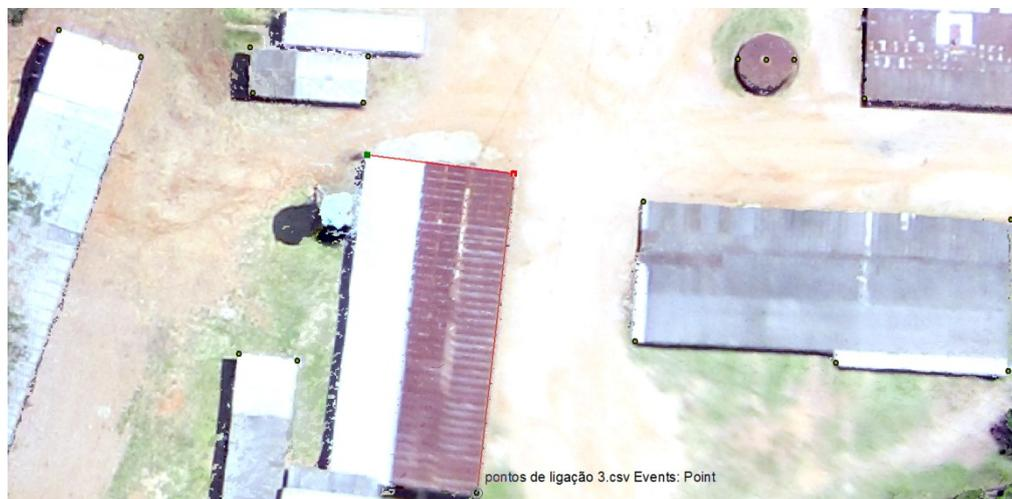
Figura 20: Vetorização a Partir dos Pontos de Ligação.
