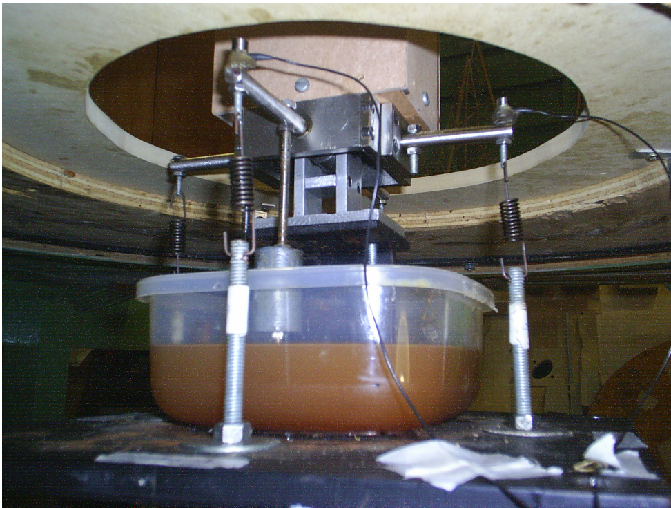
Figura 4.4 – Acelerômetros piezoelétricos fixados nas extremidades dos eixos da base flexível.
