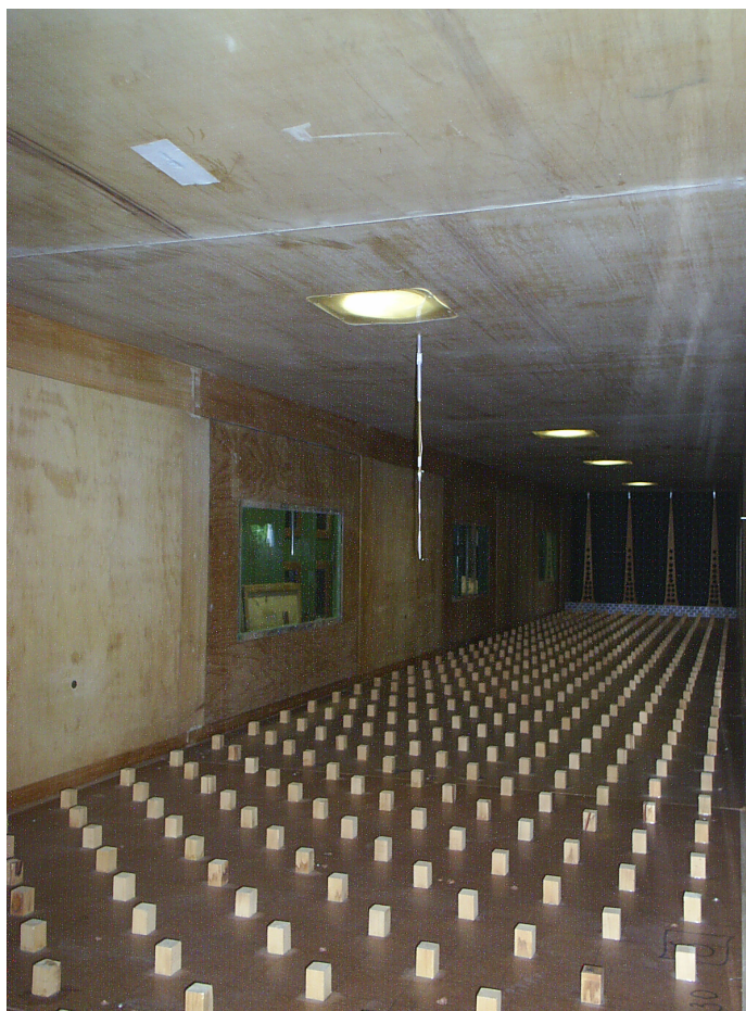
Figura 4.5 – Sonda do anemômetro de fio quente instalada dentro da seção do túnel de vento.
