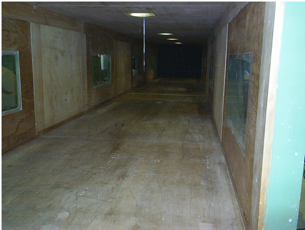
Figura 4.11 – Configuração da seção do túnel de vento sem elementos de rugosidade para vento suave.
