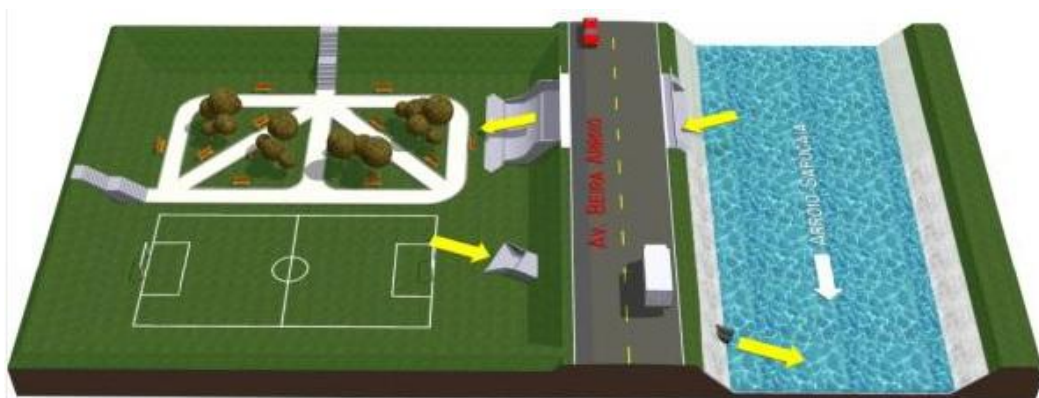
Figura 59 - Bacia de contenção do tipo off-line/off-stream, modelo previsto para o arroio Sapucaia. Fonte: IPH, 2006.
