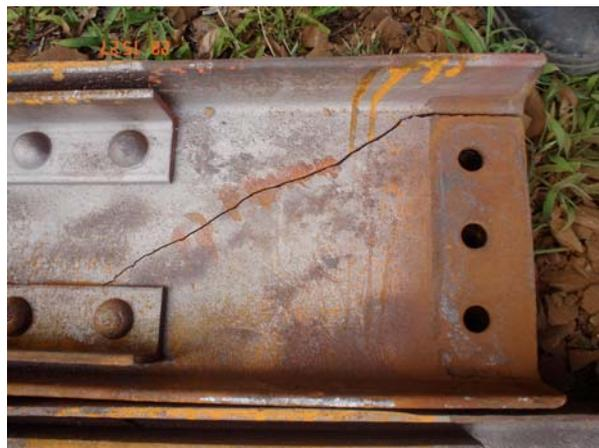
Figura (5.5) – Detalhe da trinca por fadiga numa das longarinas substituídas.
