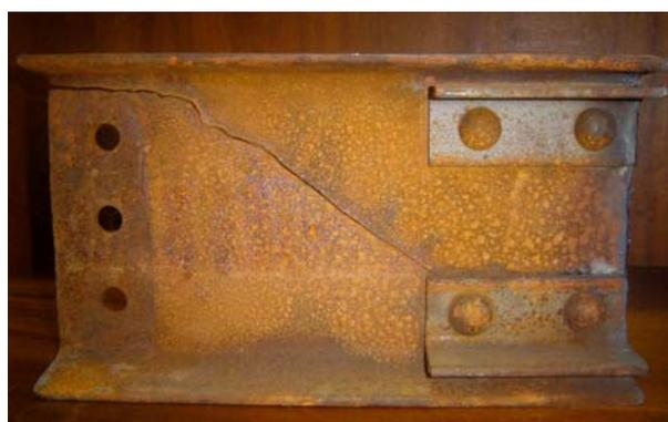
Figura (5.18) – Parte da longarina da qual foram extraídas as amostras.
