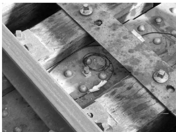
Figura (5.28) – Detalhe do posicionamento dos acelerômetros.
