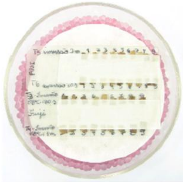
Figura 3.7 Placa de Petri contendo sílica e lâminas histológicas de vidro com epicarpo de mamões aderidos com fita dupla face para secagem
