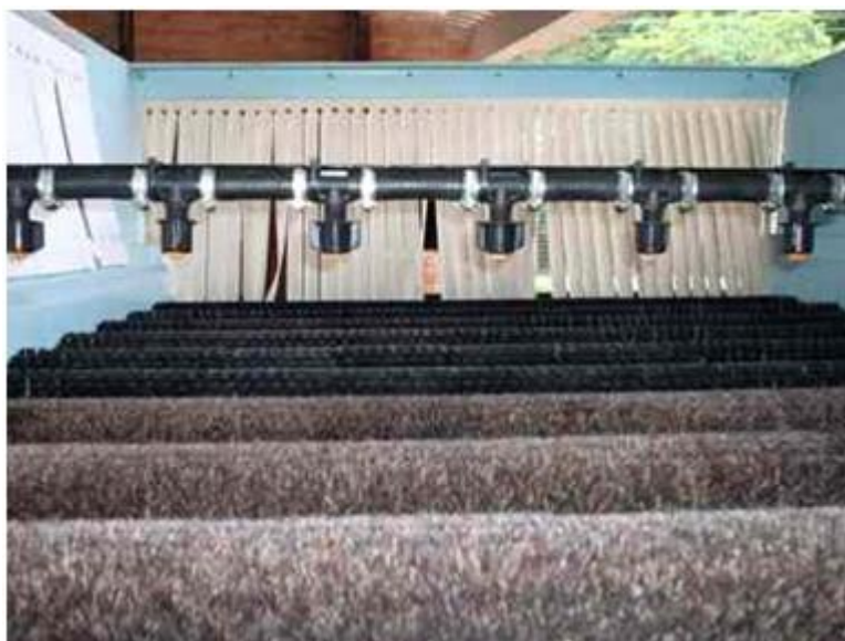
Figura 3.5 Protótipo de máquina classificadora com aspersores para o tratamento térmico e escovas de cerdas suaves.
