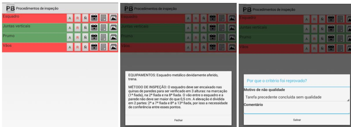
Figura 78 – Tela de inspeção, procedimento de inspeção, e registro de reprovação
