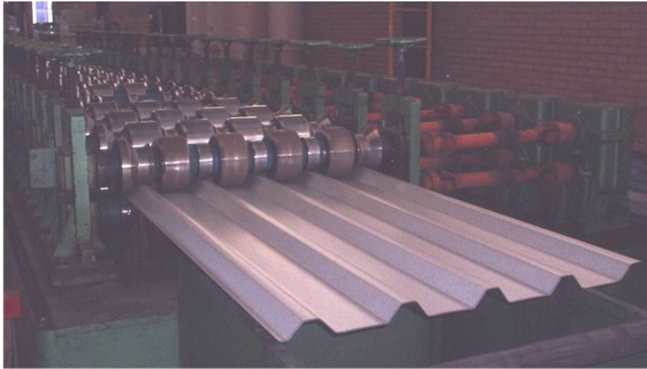
Figura 1.1: Processo de corrugação de uma telha de aço de perfil trapezoidal.
