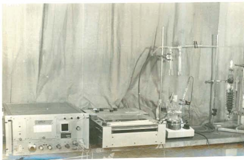
Fig. 4 - Conjunto de aparelhos utilizados no traçado das curvas de polarização em meios desarejados.
