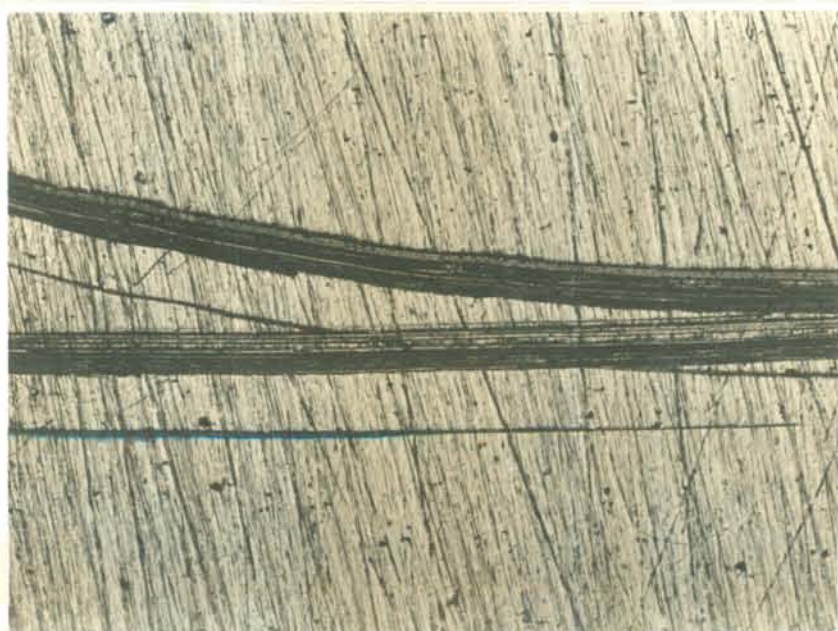
Fig.18 - Detalhe do risco feito no aço AISI 1010 em solução de 10^{-2} M de acetato de sódio + 0,25% de trietanolamina, apresentando ausência de pites a +500 mV ECS em meio arejado e sem agitação. 50 X.
