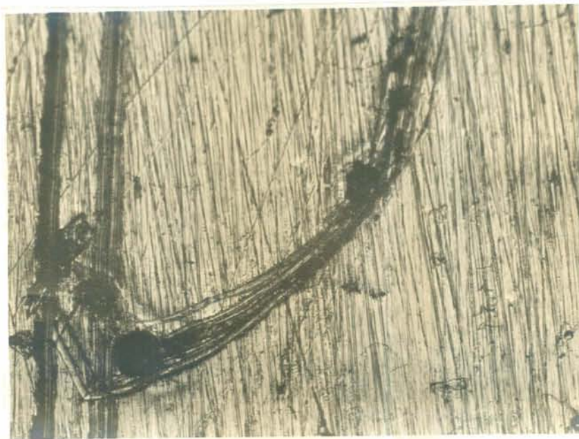
Fig.16 - Detalhe dos pites formados no aço AISI 1010 sobre o risco feito a +500 \text{ mV}_{\text{ECS}} em solução alcoólica contendo 10^{-2} \text{ M} de acetato de sódio, e também em solução contendo 0,25% de "Proal", em meio arejado e sem agitação.100X
