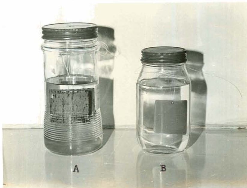
Fig. 5 - Amostras do aço AISI 1010, suspensas em meio contendo álcool etílico comercial, para ensaios a longo prazo. A = Álcool etílico sem aditivo; B = Álcool etílico com aditivo.
