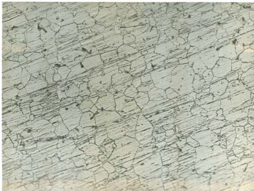
Fig. 1 - Microestrutura do aço AISI 1010 mostrando tamanho de grão nº 7, segundo a norma da ABNT. 100 X
