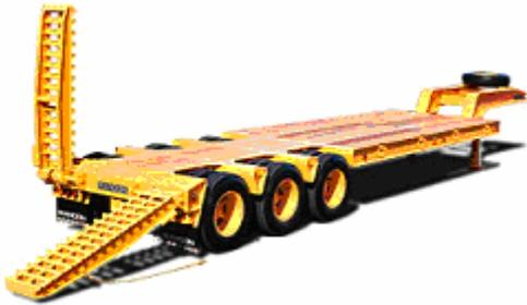
**Fotografia 5 - Semi-reboque plano 3 eixos**
