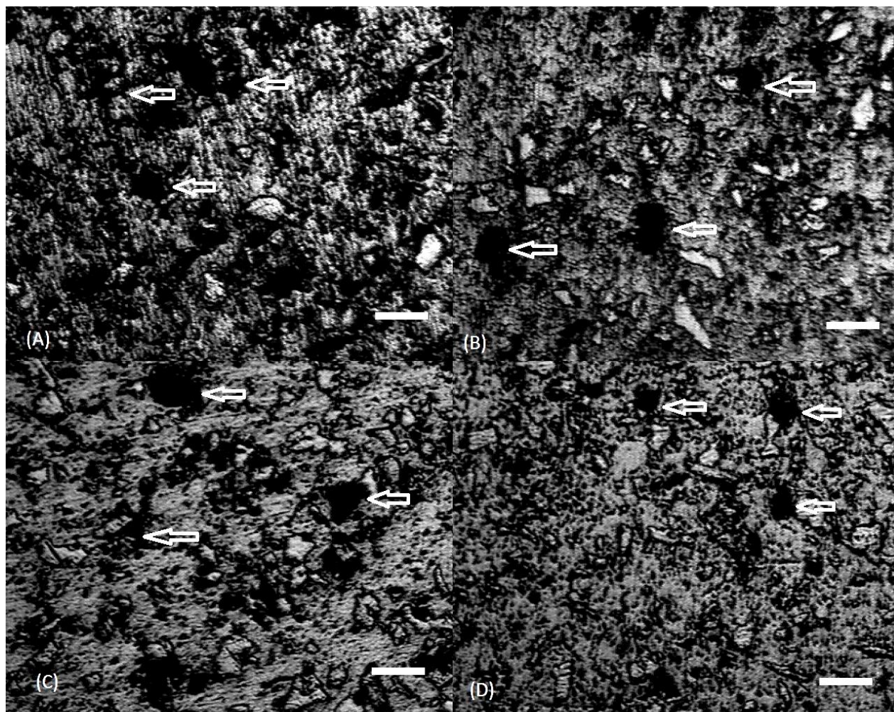
Figura 24. Liga 80% Cu-20% Nb sem ataque químico; Partes (A)- 100 MPa; (B)- 200 MPa; (C)- 300 MPa; (D)- 400 MPa
