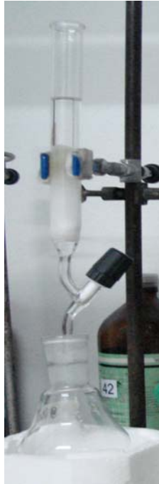
Figura 8. Coluna de sílica-gel utilizada para eluição do extrato orgânico e que auxiliou a separação do 5-hidroximetilfurfural da patulina.
