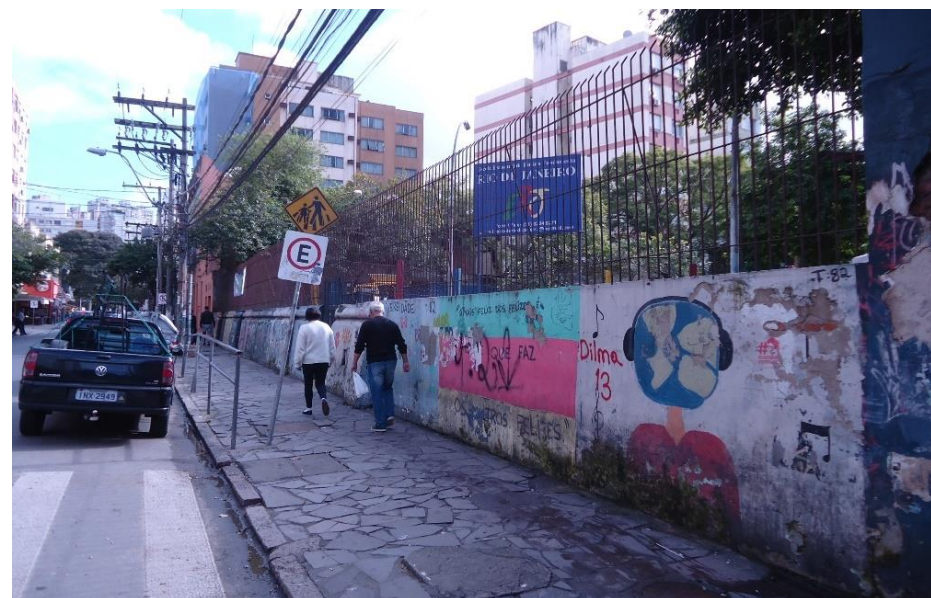
FIGURA 24: Trecho de calçada na Rua Gen. Lima e Silva em frente à EEEF-RJ. Na foto percebe-se uma tentativa de diminuir o risco do tráfego intenso de veículos com a instalação de proteção metálica. Apesar da proteção, este elemento acaba reduzindo a largura útil da calçada e dificultando a passagem de pedestres. (Fonte: Arquivo pessoal)
