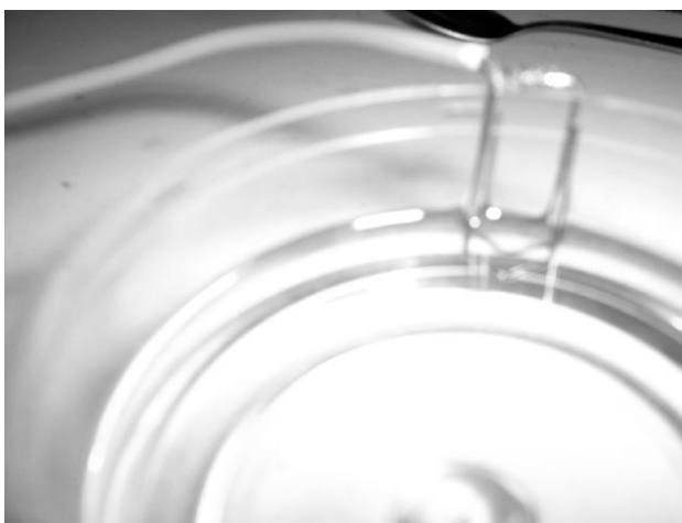
Figura 14: Na substância não condutora, nenhuma bolha se forma ao redor dos cliques.
