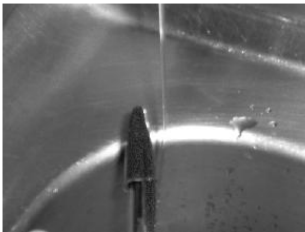
Figura 8: Filete de água sofre um desvio depois que a caneta atritada é aproximada.
