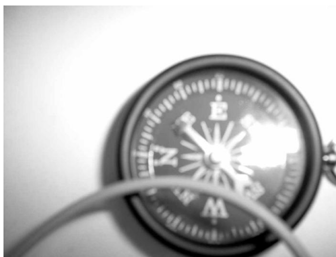
Figura 18: Campo magnético criado pela corrente elétrica no condutor gera um desvio na agulha da bússola.
