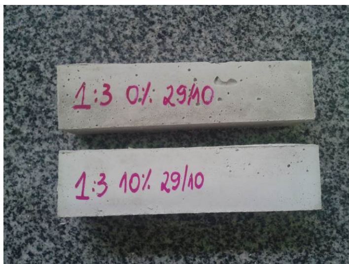
Figura 52 – comparação de coloração de corpos de prova de traço 1:3 sem adição de \text{TiO}_2 (acima) e com 10% de adição de \text{TiO}_2 (abaixo).
