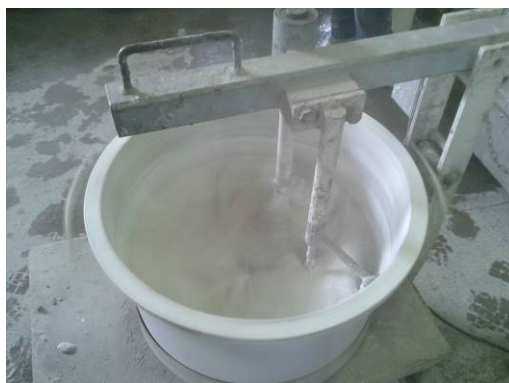
Figura 25 – argamassadeira com capacidade para 40 litros sendo utilizada para a mistura das argamassas.
