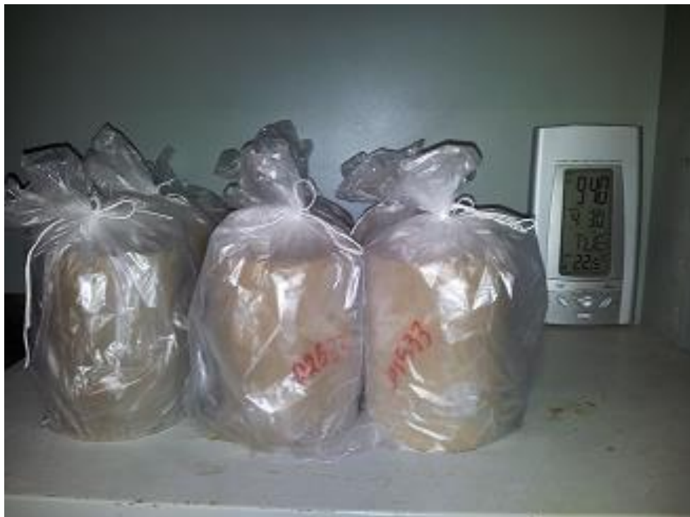
Figura 3.5 - Corpos-de-prova na câmara de cura
