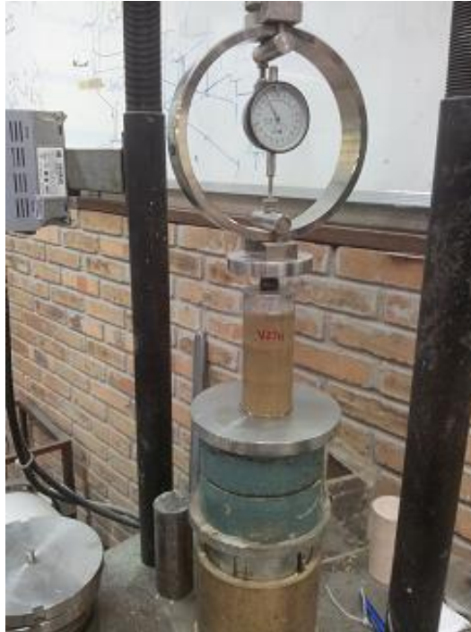
Figura 3.7 - Ensaio de Resistência à Compressão Simples.
