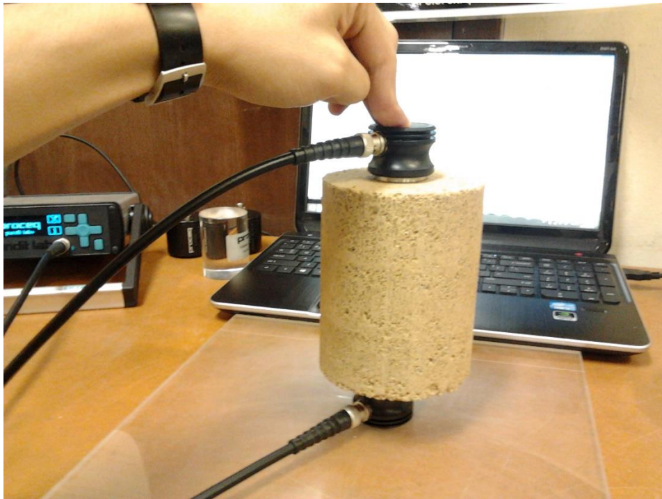
Figura 3.10 - Execução do Ensaio de Medidas de Rigidez Inicial.
