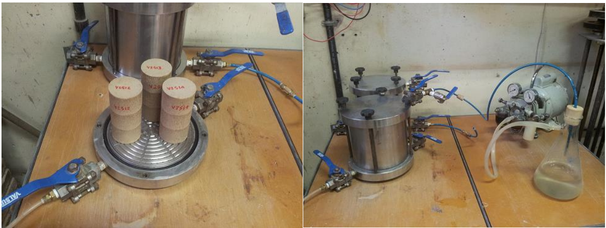
Figura 3.8- Corpos-de-prova e execução do ensaio de vácuo-saturação.
