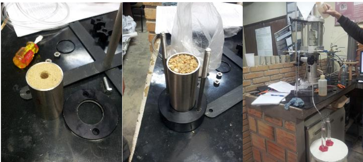
Figura 3.12 - Corpo-de-prova e execução do ensaio Pinhole.
