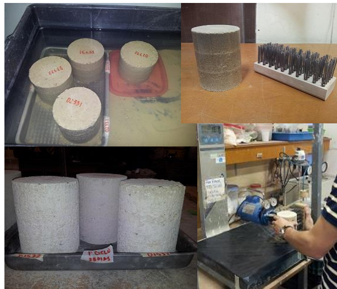
Figura 3.6 - Ciclos de molhagem, secagem e escovagem
