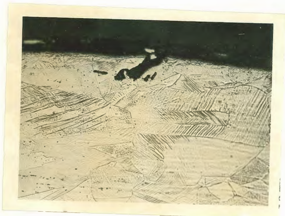
Fig.57. Trincas transgranulares. Microscópio ótico, 200 X. NaCl 10%. Trincas localizadas sobre o CP, fora da zona de estrição. Matriz circundante deformada.
