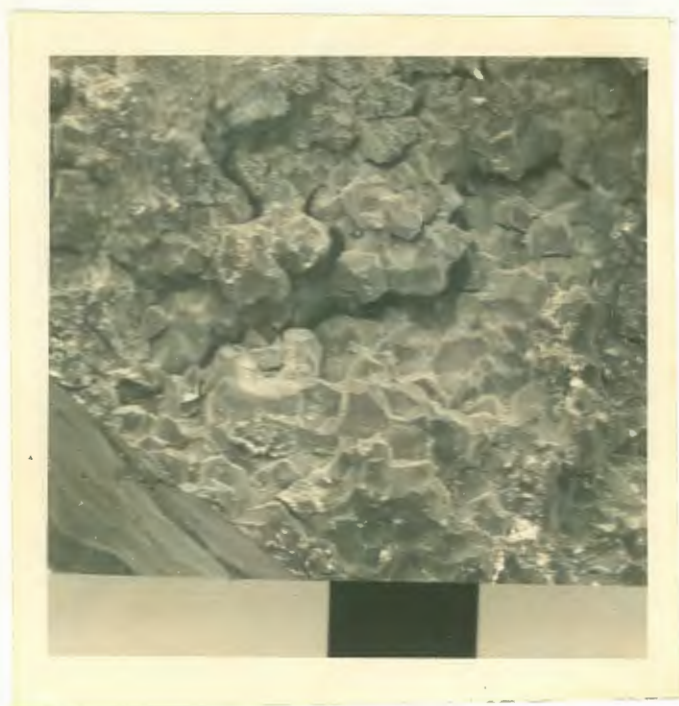
Fig.49. Superfície de fratura intergranular. MEV, 100x. MgCl_2 + NaNO_3 , -70 mV_H .
