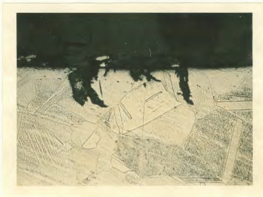
Fig.56. Trincas transgranulares. Microscópio ótico, 200 x. NaCl 10%. Estas trincas situam-se fora do CP, entre a região útil e a região de seção original. A matriz não encontra-se deformada.
