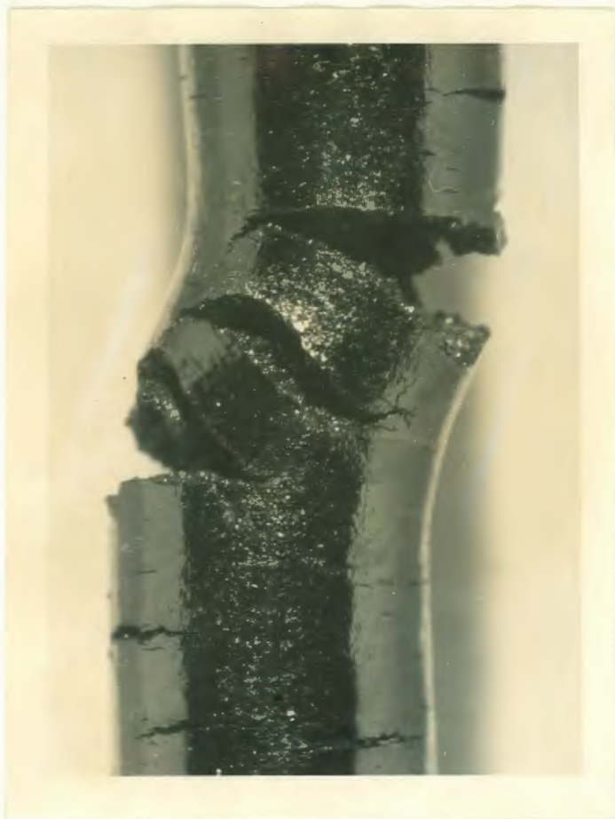
Fig.46. Aspecto geral do CP. 20x. MgCl_2 + NaNO_3 . -80 mV_H .
