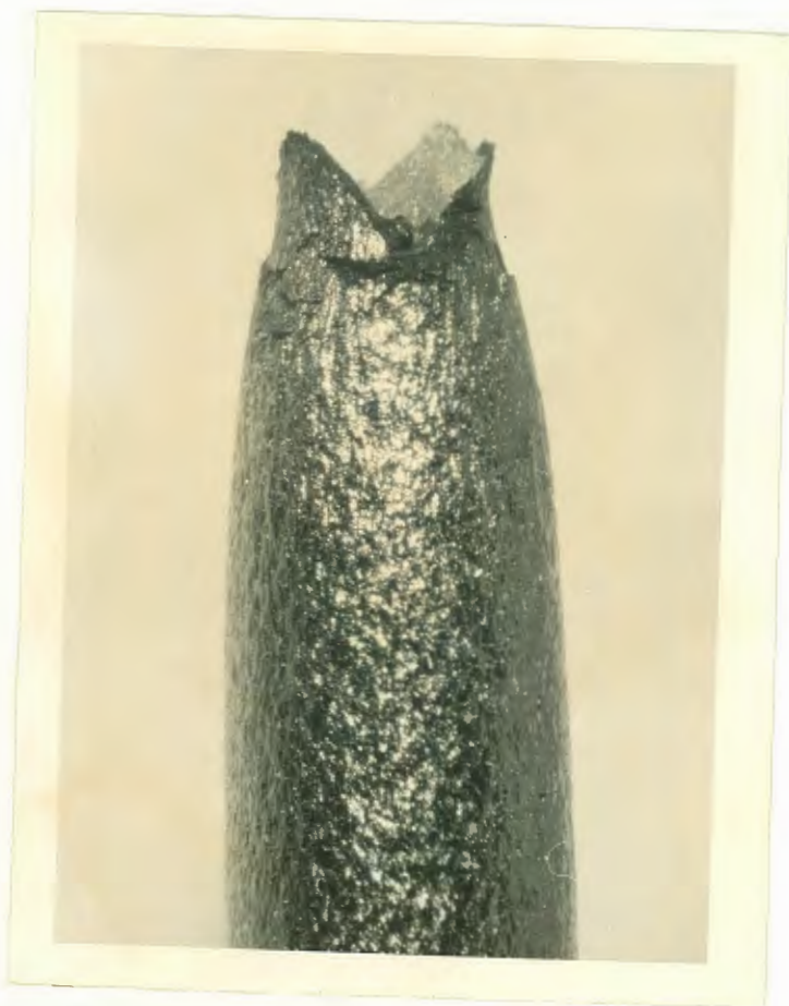
Fig.47. Aspecto geral do CP. 20x. MgCl_2 + NaNO_3 . -90 mV_H .
