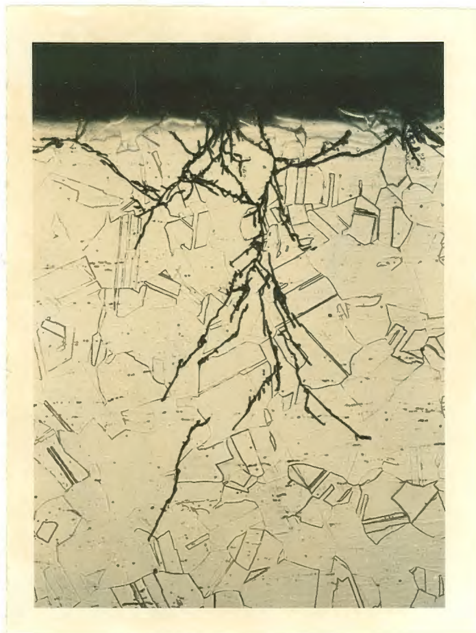
Fig.25. Trincas transgranulares. Microscópio óptico, 100 x. \text{MgCl}_2 puro, -110 \text{ mV}_H .
