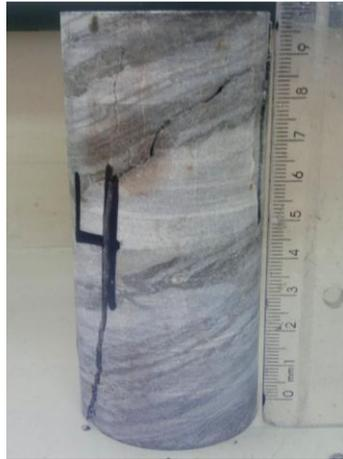
Dois parâmetros importantes para a determinação das propriedades de resistência dos maciços são a coesão e o ângulo de atrito interno, estimados por meio de ensaios triaxiais utilizando o critério de Mohr-Coulomb.
