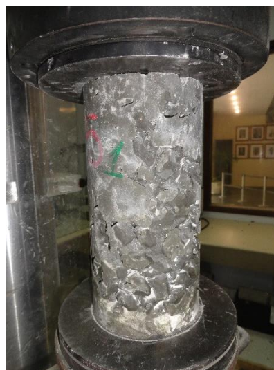
Figura 81 – Corpo de prova do traço de CAD com EMA 1,01 mm no momento da ruptura.
