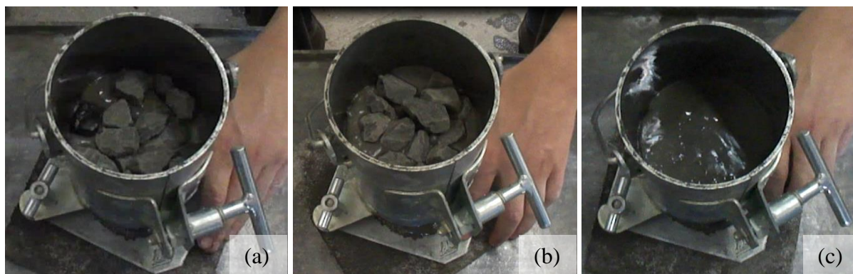
Figura 51 – Sequência de moldagem dos corpos de prova: (a) lançamento do agregado sobre a matriz; (b) vibração do conjunto; (c) incorporação total do agregado pela matriz.
