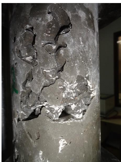
Figura 80 – Corpo de prova do traço de CAD com EMA 1,65 mm no momento da ruptura.
