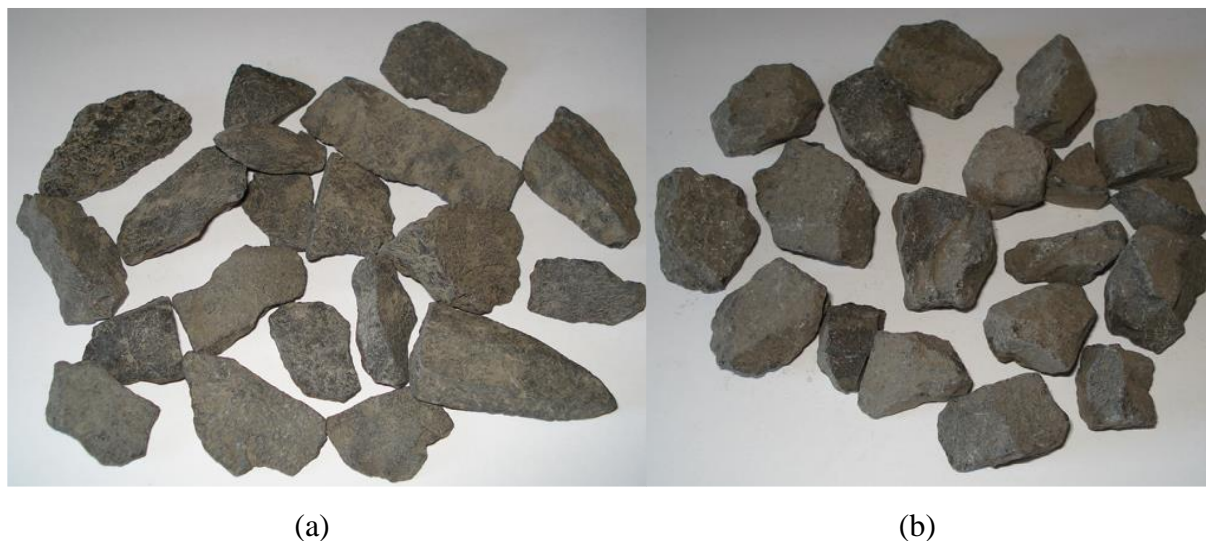
Figura 4 - Agregado com índice de forma (a) 4,0 e (b) 1,8 (ARNDT et al. , 2007).
