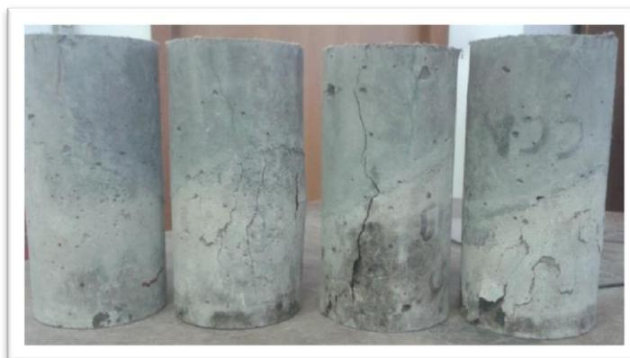
Figura 68 - Corpos de prova rompidos - compósito-30%4h/concreto.
