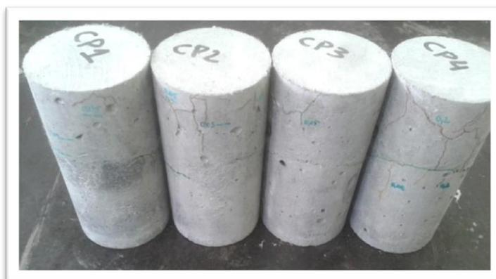
Figura 64 - Corpos de prova rompidos - compósito-REF/concreto.
