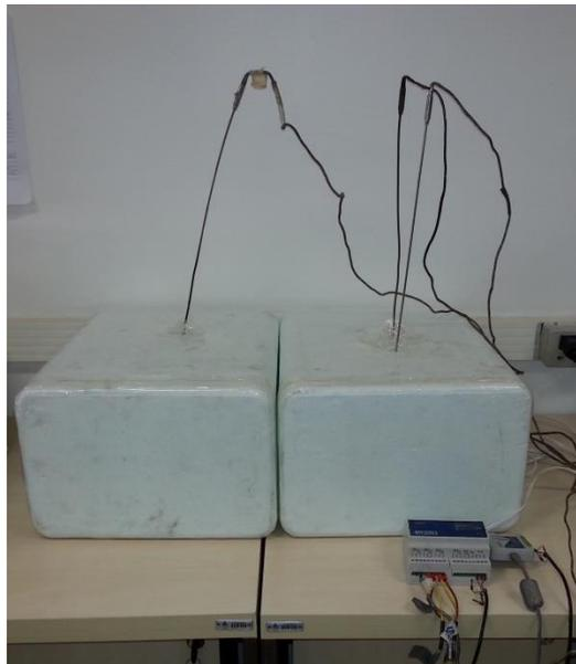
Figura 37– Ensaio de liberação de calor de hidratação.
