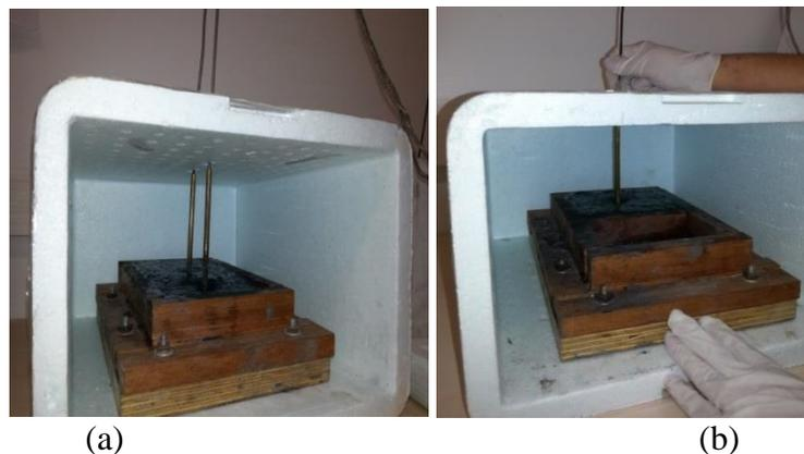
Figura 36 – Posição dos termopares na amostra para ensaio de curva de liberação de calor, (a) posição dos termopares na fôrma com 100% do volume utilizado; (b) e na fôrma com 50% do volume utilizado.
