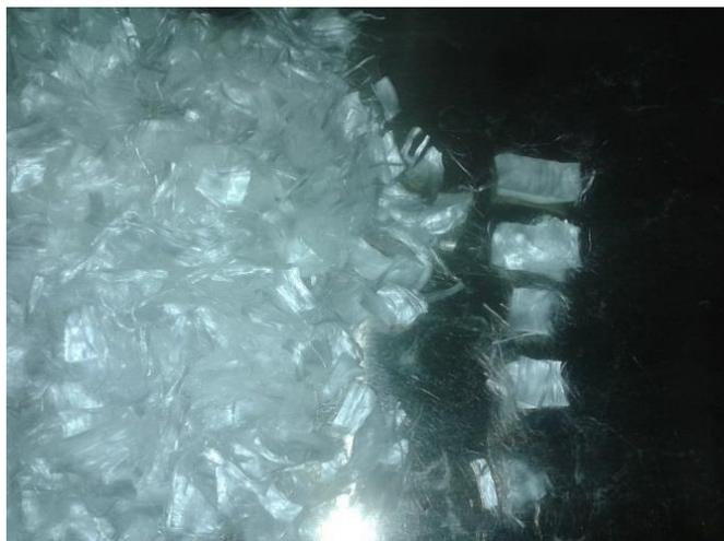
Figura 30 – Fibras de polipropileno utilizadas na pesquisa.
