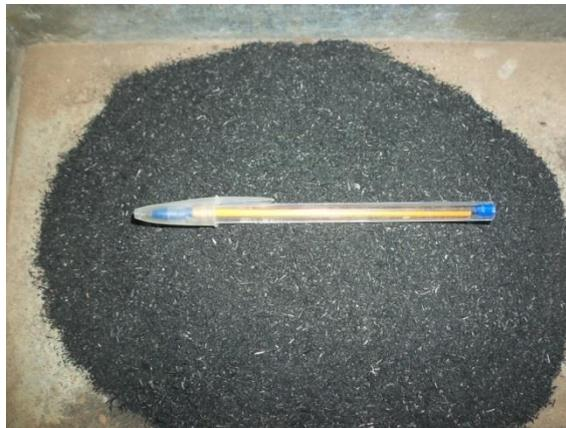
Figura 28 – Cinza de casca de arroz obtida do processo de queima sem controle de temperatura.
