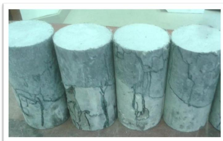
Figura 66 - Corpos de prova rompidos - compósito-30%8h/concreto.
