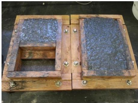
Figura 35– Moldagem das amostras.
