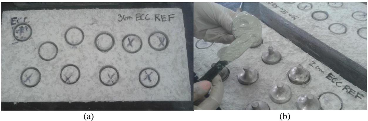
Figura 39 – Etapas do ensaio (a) cortes com o diâmetro de 50 mm; (b) colagem dos discos com resina epóxi.
