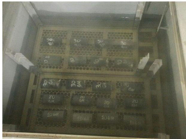
Figura 34- Etapa de execução do ensaio de absorção e índice de vazios – Fervura por 5 horas.
