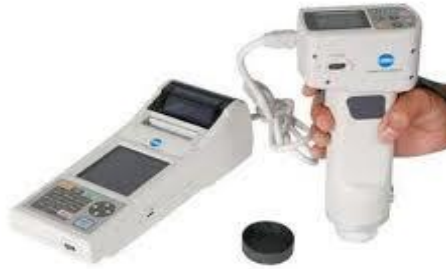
Figura 8 - Calorímetro (modelo CR-300, Minolta Co. Ltd, Japão) utilizado para determinar a cor dos filmes biodegradáveis.
