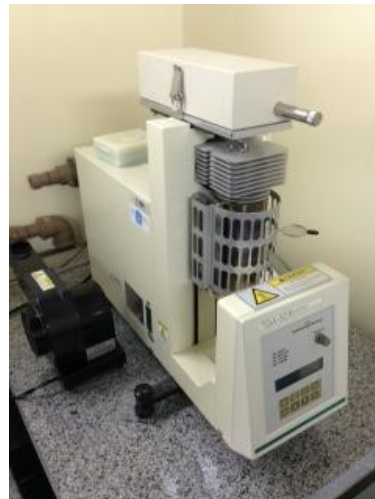
Figura 10 - Analisador termogravimétrico utilizado para análise de estabilidade térmica dos filmes biodegradáveis.
