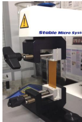
Figura 4 - Análise de propriedades mecânicas de filme biodegradável realizada em texturômetro TA-XT2 (Stable Micro Systems, Reino Unido).
