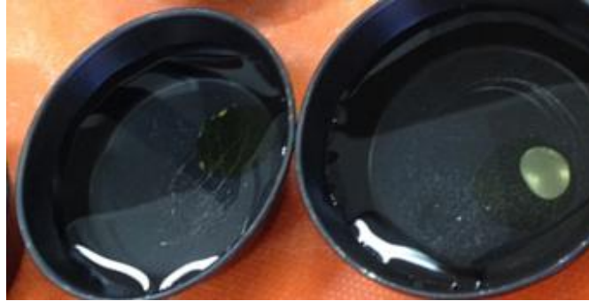
Figura 6 – Avaliação da solubilidade dos filmes biodegradáveis após 24h de contato com a água.
