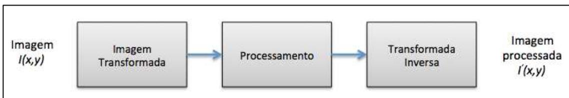
**Figura 19.** Esquema de processamento no domínio da frequência usando a transformada de Fourier.
