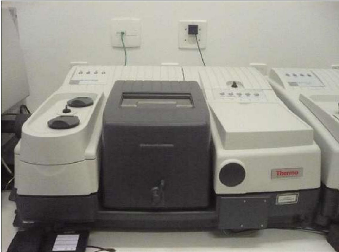
**Figura 3.** Espectrorradiômetro Nicolet 6700 utilizado para coleta de assinaturas de emissividade das amostras de solo.
