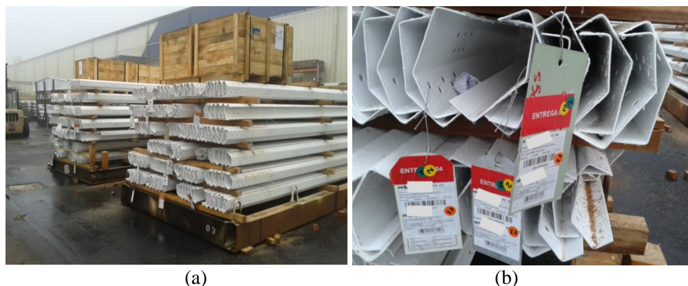
Figura 46 – (a) Carregamento em skid e (b) etiquetas coloridas para identificação da etapa.
