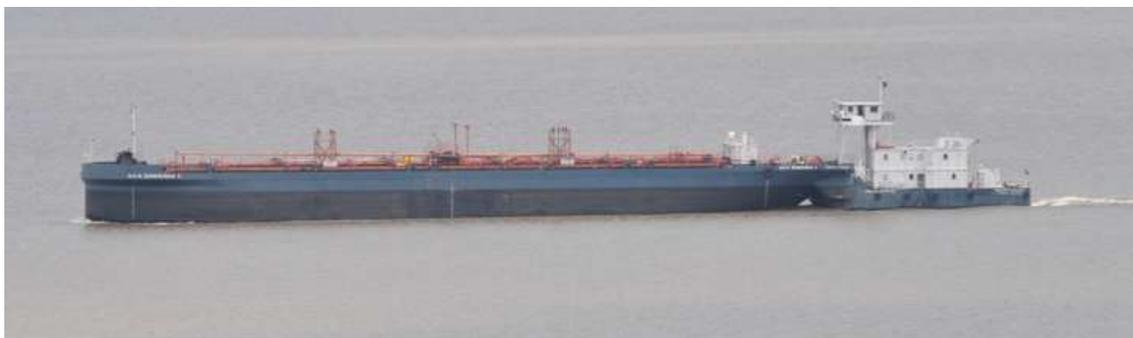
Figura 3.2 - Sistema Empurrador Barcaça (Fonte: Navegação Guarita)
