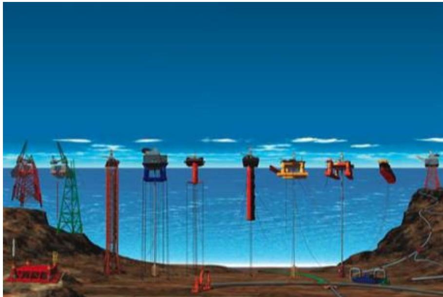
Figura 2: Sistemas estruturais para a exploração de petróleo do mar. Da esquerda para direita: plataformas fixas, TLPs ( Tension Leg Platform ), spar buoy, semi-submersível, navio FPSO (PROMINP, 2008 apud COSTA, 2008).
