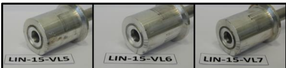
Figura 4.7: Amostras de validação do envelope de parâmetros 2 do processo de HFDB para TCTE. Fonte: próprio autor
