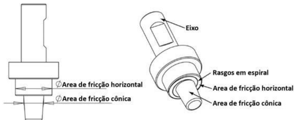
Figura 3.2: Ilustração esquemática de uma ferramenta HFDB para união de tubos e chapas de tubo para aplicação na manufatura de trocadores de calor de tubo espiral. Fonte: próprio autor
