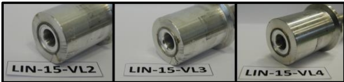
Figura 4.6: Amostras de validação do envelope de parâmetros 1 do processo de HFDB para TCTE. Fonte: próprio autor
