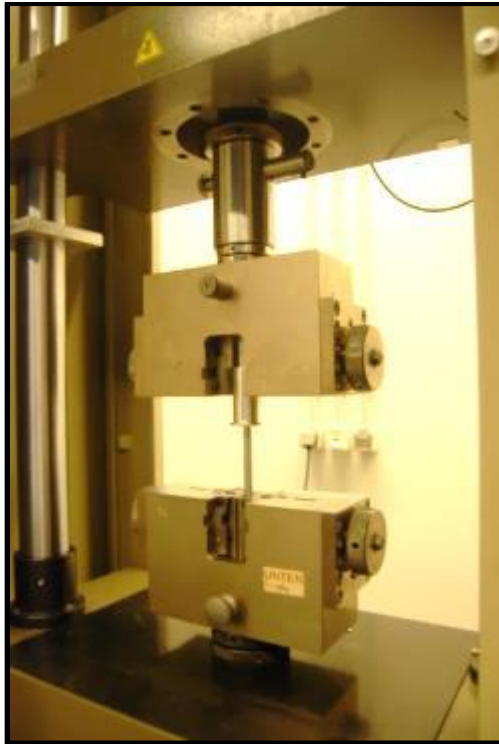
Figura 3.10: Máquina de ensaios de tração com amostra montada. Fonte: próprio autor
