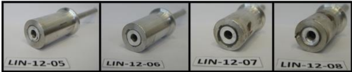
Figura A.4: Amostras usinadas dos estudos preliminares do processo de HFDB para TCTE, amostras LIN-12-05 até LIN-12-08. Fonte: próprio autor
