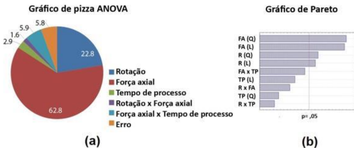
Figura 4.3: (a) Gráfico de pizza da ANOVA mostrando a influência de cada fator e suas interações na resposta – limite de resistência. (b) Gráfico de Pareto para analisar o p-value de cada fator mostrando sua relevância para o processo. Fonte: próprio autor
