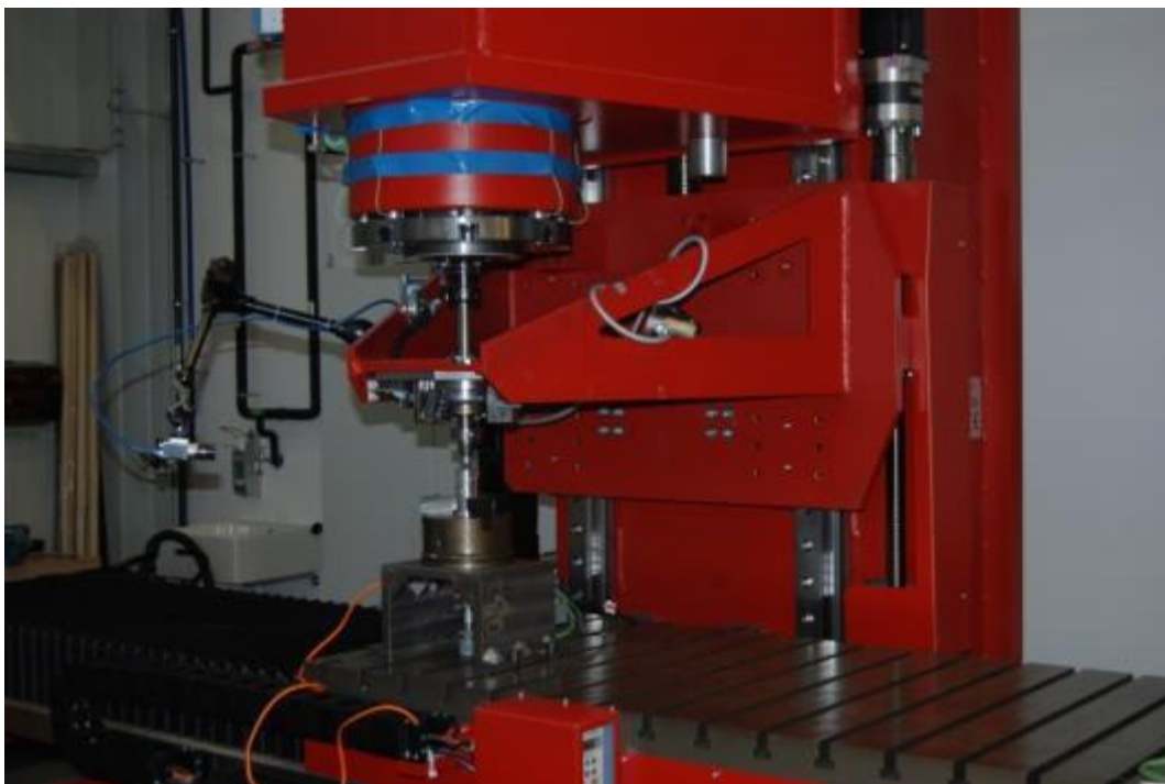
Figura 3.6: Máquina de solda FS-RAS mostrando o equipamento, mesa de trabalho, sistema de fixação e amostra. Fonte: próprio autor
