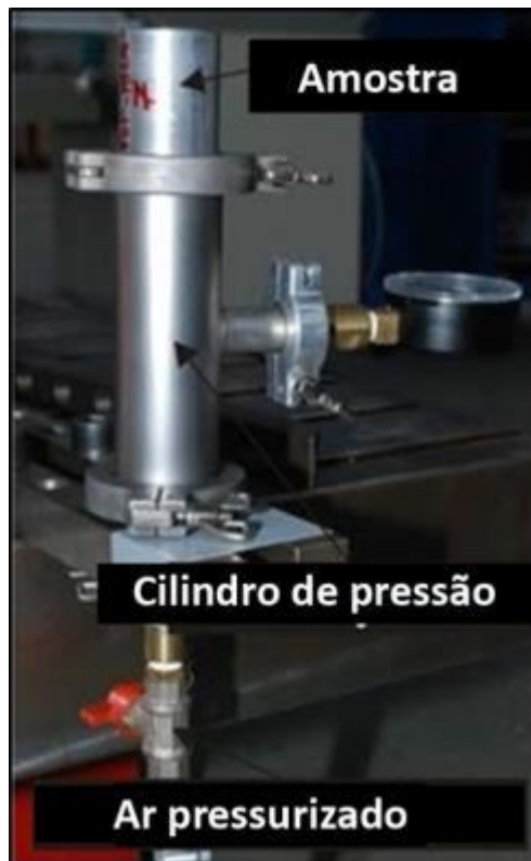
Figura 3.9: Sistema de teste para estanqueidade de 10^{-5} mbar l/s das amostras. Fonte: próprio autor
