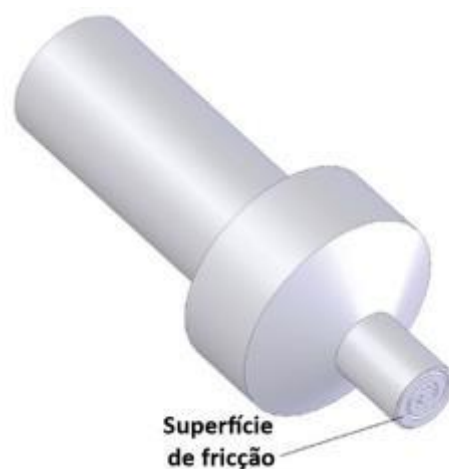
Figura 2.10: Ferramenta padrão de HFDB para a união de chapas finas ou chapas finas em substratos. Fonte: adaptado pelo autor de ROOS (2010) p. 38
