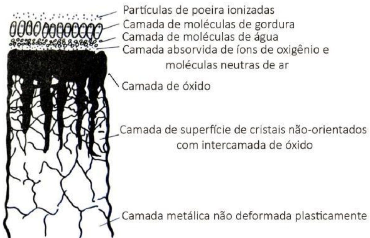
Figura 2.7: Superfície de um metal em contato com o ambiente, mostrando as diferentes “camadas absorvidas” presentes na superfície. Fonte: adaptado pelo autor de KAZAKOV (2013) p. 31
