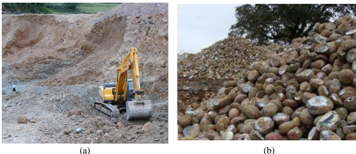
Figura 3 – Extração de ágata nas minas: (a) escavação na área de extração; (b) geodos extraídos.
