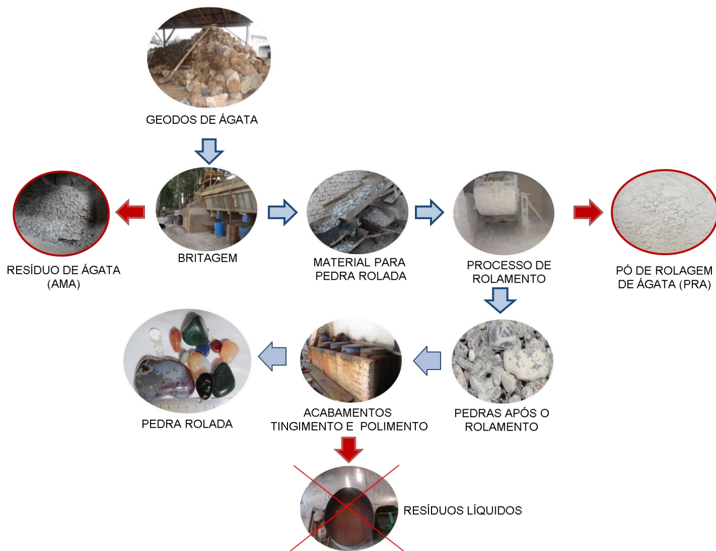
Figura 5 - Processo de beneficiamento dos geodos de ágata
