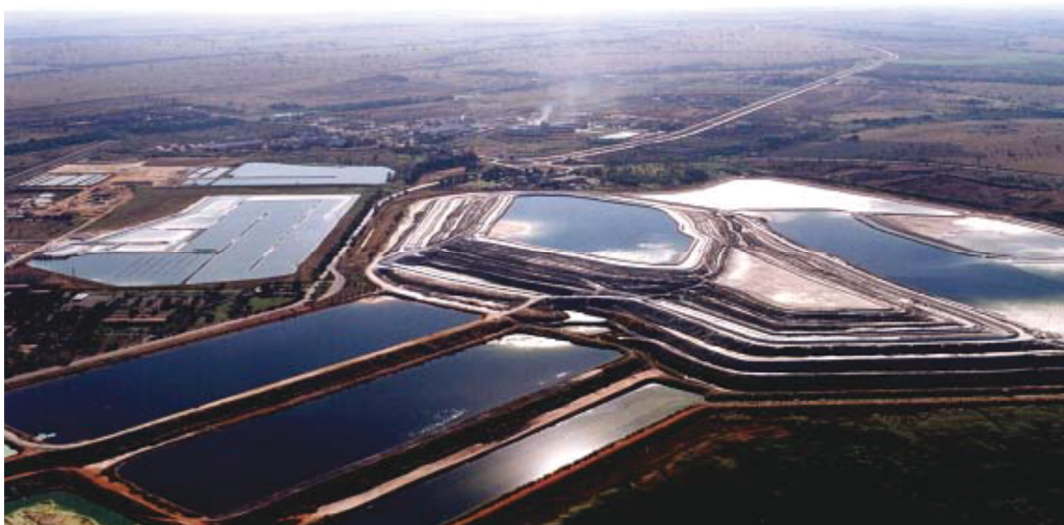
Figura 3 - Disposição a úmido do fosfogesso Canut (2006)
