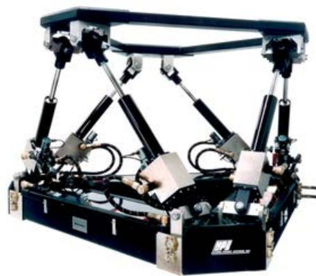
b) Manipulador do tipo paralelo (Fonte: Robotics Laboratory).
