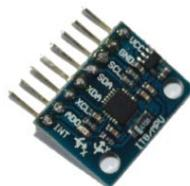
Figura 4.5 – Placa com acelerômetro e giroscópio MPU-6050.
