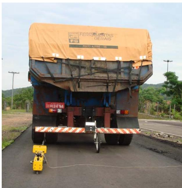
Figura 5.30: Determinação das deflexões com viga eletrônica na pista experimental desta pesquisa
