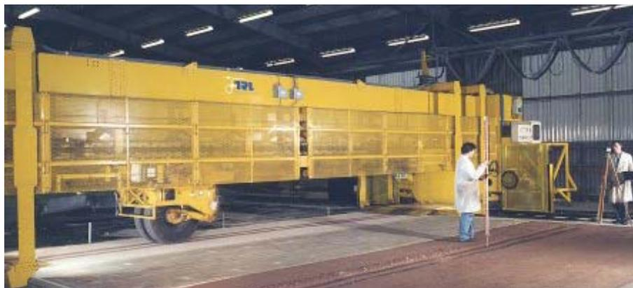
Figura 2.28: Simulador de tráfego linear do TRL (TRB, 2006)
