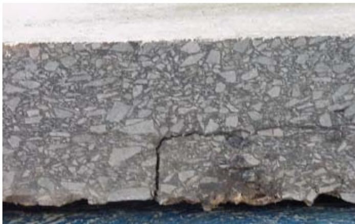
Figura 2.32: Desvio do trincamento pelo geotêxtil (Viera, 2002)
