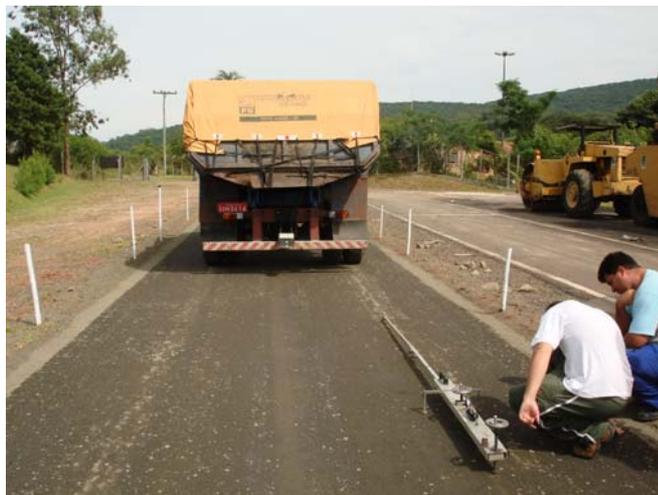
Figura 5.26: Avaliação da deflexão sobre a camada de base da pista experimental desta pesquisa
