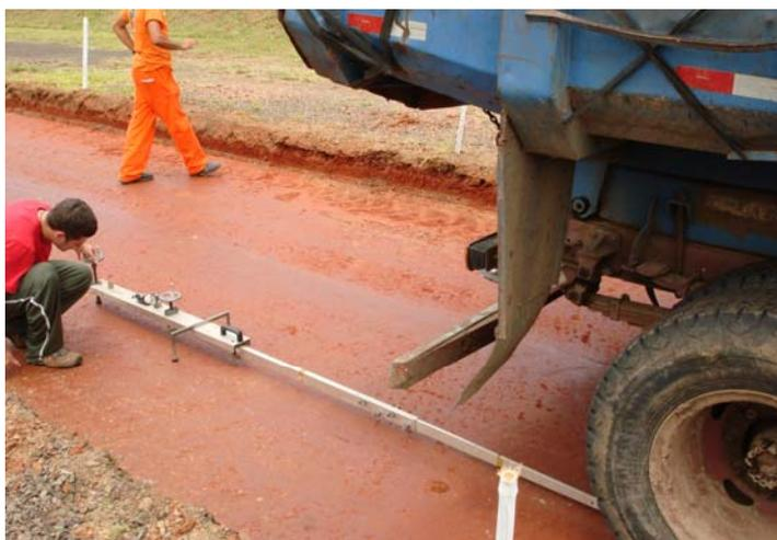
Figura 5.23: Avaliação da deformabilidade elástica com viga Benkelmann no local do experimento desta pesquisa
