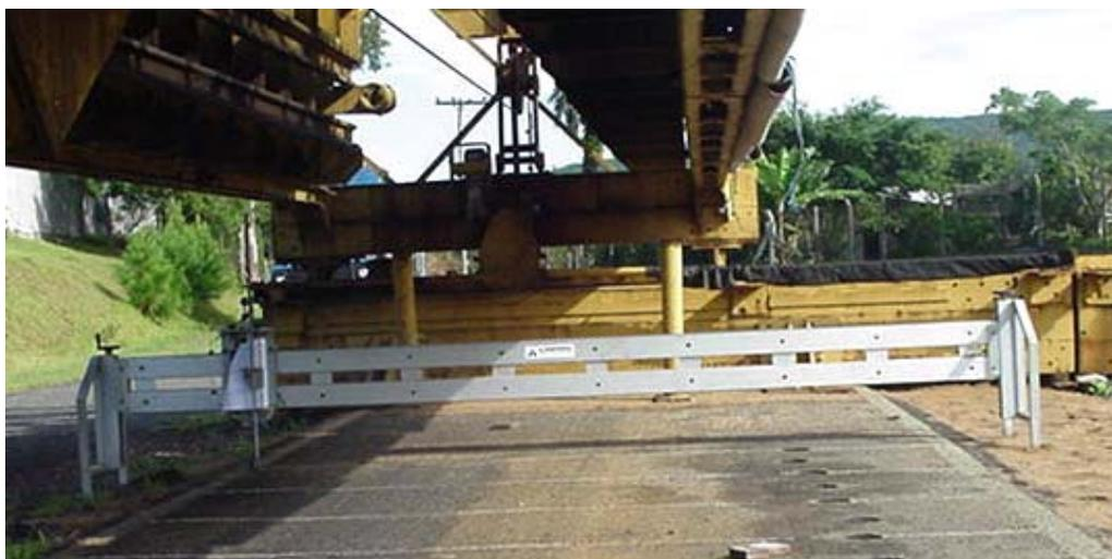
Figura 5.57: Transverso-perfilógrafo para avaliação de ATR
