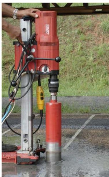
Figura 5.33: Extração de amostras com sonda rotativa
