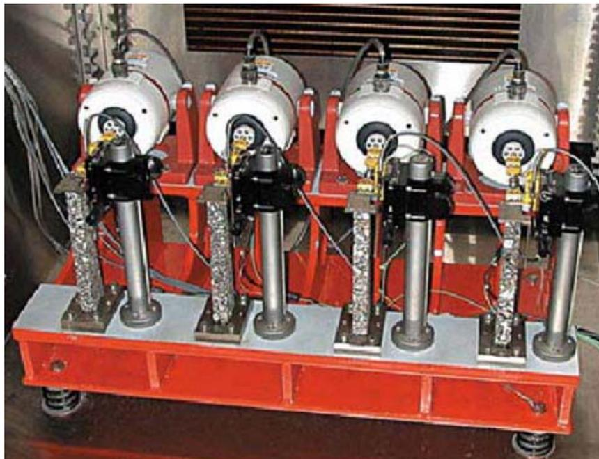
Figura 2.13: Equipamento para ensaio de módulo complexo (Brosseaud, 2004)
