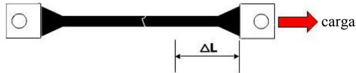
Figura 2.6: Esquemática do ensaio de tração direta
